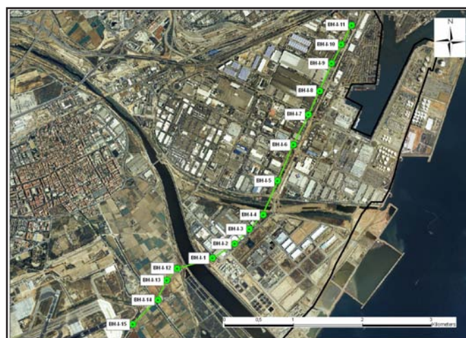
Ubicación de los pozos de inyección de la barrera hidráulica.
